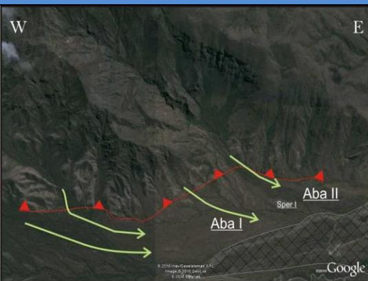
Imagen satelital Google Earth, mostrando aguas arriba del río San Isidro al situación estructural y geomorfológica del sector. En líneas punteadas naranjas se remarca el frente de levantamiento precordillerano, en líneas verdes se señalan las áreas de aporte de sedimentos que erodan a través de abanicos aluviales (Aba I y Aba II). Puede observarse antiguas superficies de erosión (Sper).
