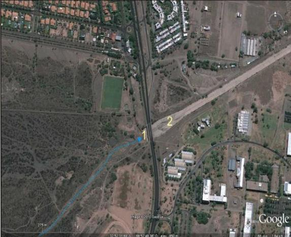
Imagen satelital Google Earth en la cual puede observarse en planta y con orientación SW-NE el canal de evacuación de excedentes auvionales Papagayos. Las imágenes de detalle se ubican abajo. El número 1 hace referencia a la figura 37 , el 2 hace referencia a la figura 38. En línea azul punteada, se indica la dirección del flujo del cauce.
