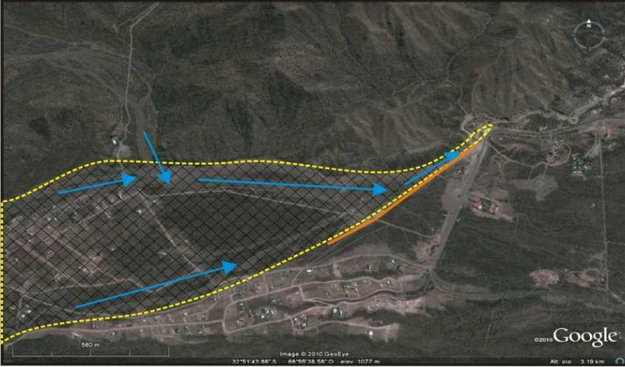
Imagen satelital Google Earth en la cual puede observarse en las líneas punteadas amarillas la llanura de inundación del río San Isidro, las líneas azules representa el sentido de escurrimiento del río, en línea naranja se puede observar el paredón de la presa Dique San Isidro.
