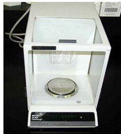
Figura 17. Balanza analítica digital con 0,1 mg de precisión. Fuente: A&D Company ,Marketing Department , Limited.2015
