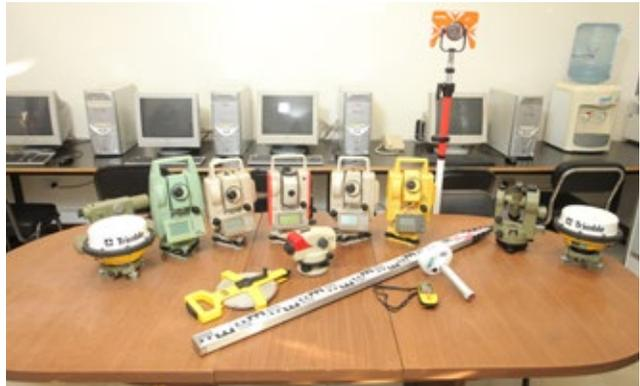
Figura N° 34: Laboratorio de Agrimensura
